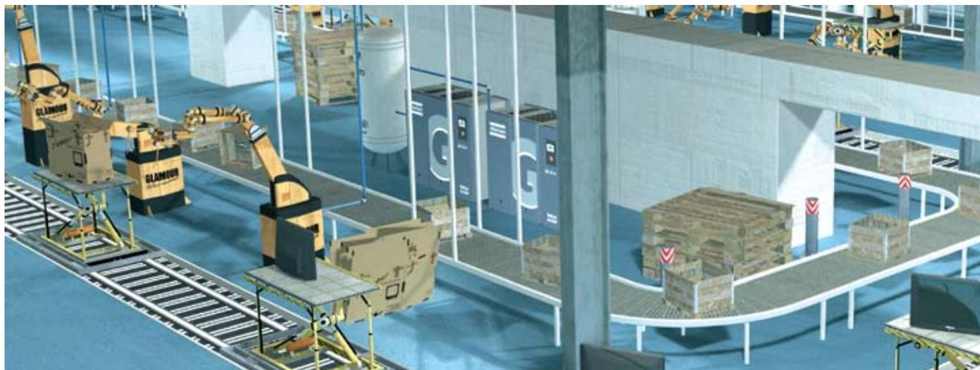
阿特拉斯·科普柯GA现场型压缩空气系统可以放置再生产现场为用气点直接提供可靠的压缩空气。不在需要独立的压缩机房或专门的、昂贵的管道系统。GA是为苛刻条件设计的最高效的压缩机，它可保障生产的平稳、可靠。
