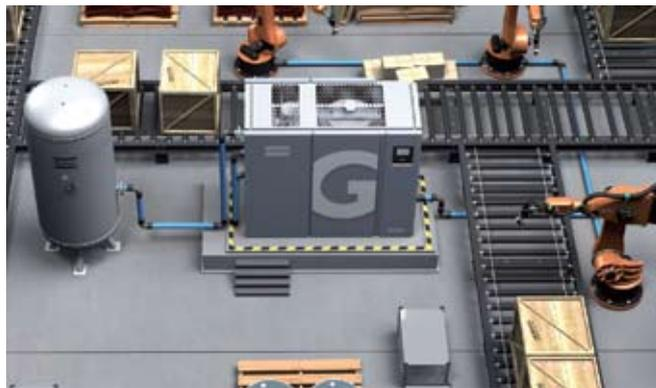
GA现场型：噪音低，可以直接摆放在用气点，全内置机器节省空间，降低了管网成本。
