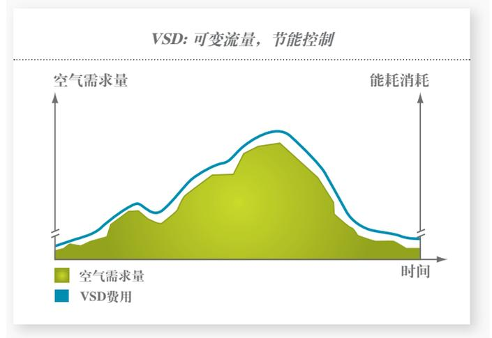
因为没有不必要的能源消耗，GA VSD可以使能耗降低35%甚至更多。成本的降低平均占整个压缩机寿命周期成本的22%。总之，VSD压缩机与固定转速压缩机相比额外投资成本在1至2年内即可收回。
